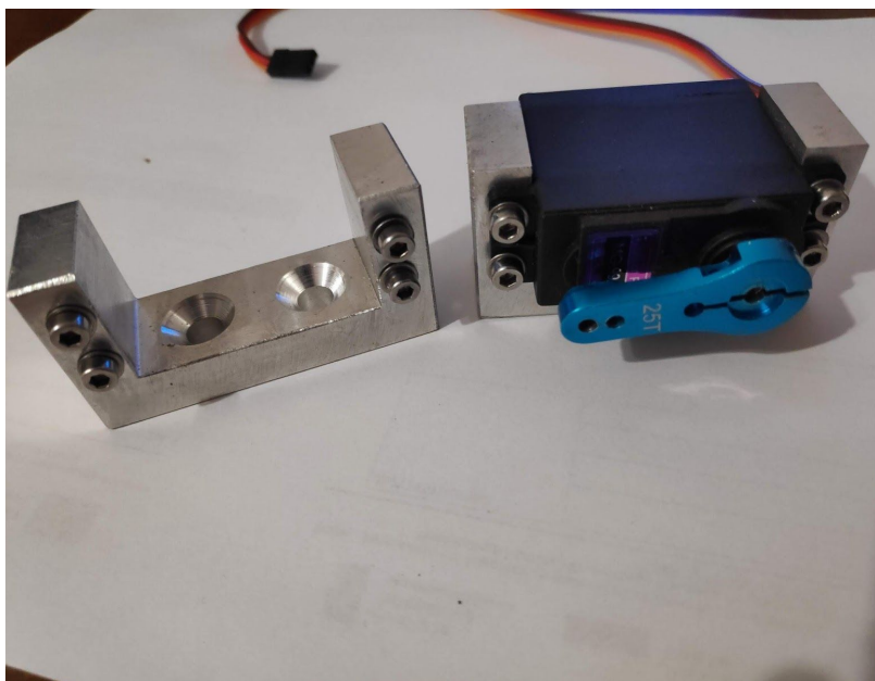
Rysunek 1.2 - Mocowanie serwomechanizmów
